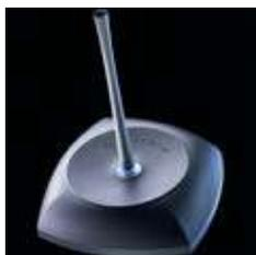
**RF-Basis (БАЗОВАЯ СТАНЦИЯ)** - Устройство, которое по радиоканалу обеспечивает связь компьютеров системы с ORDERMAN-ами официантов.
