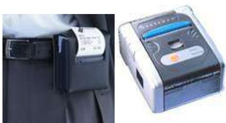
**ПЕРЕНОСНОЙ ПРИНТЕР** - Портативный принтер, подключенный по радиоканалу к конкретному ORDERMAN-у. Обычно используется для распечатки предварительного счета, прямо около столика клиента.
